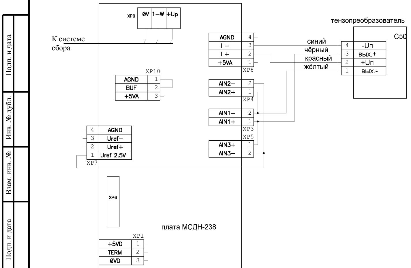
*Рисунок А.3 – Схема соединений ДПА-327-02 и ДПА-327-02Е*
