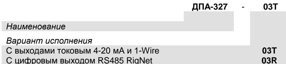
Рис. 1 - структура условного обозначения изделия
