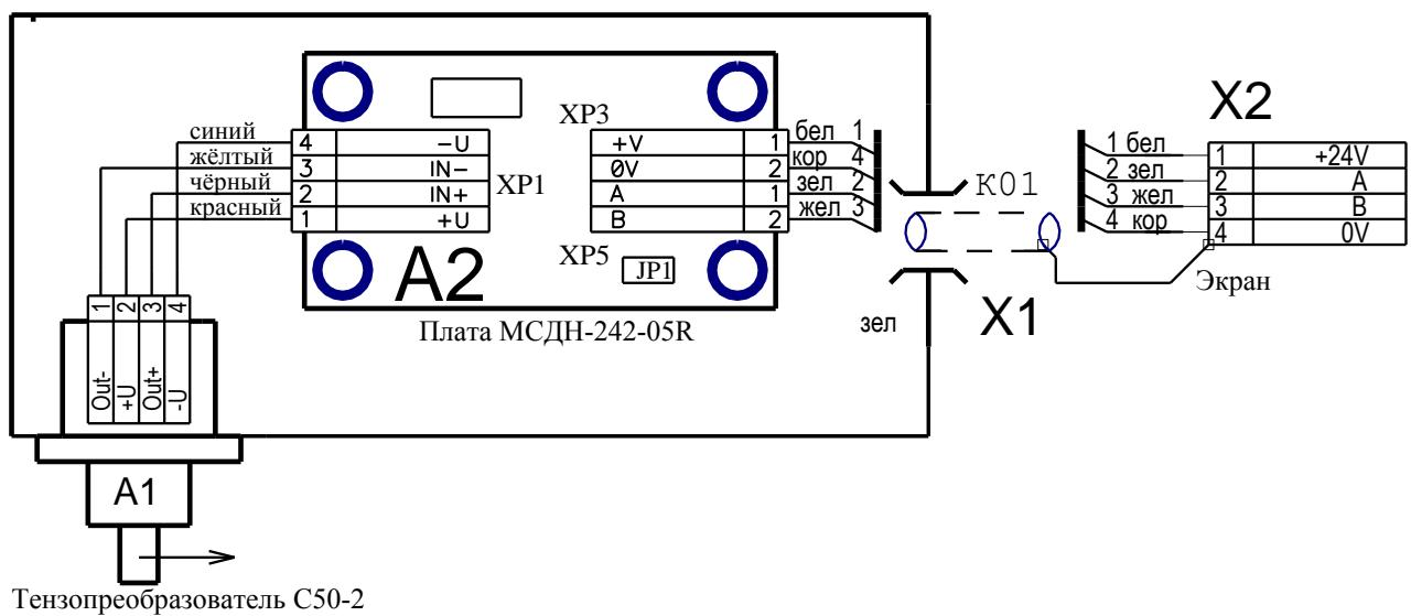
Рисунок A.5 – Схема соединений ДПА-327-03R
