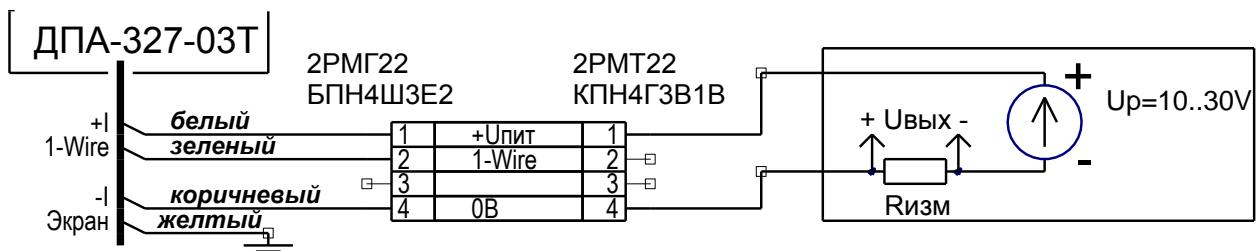
*Рисунок А.2 – Схема подключения ДПА-327-03Т к токовому входу. (В СГТИ Разрез-2 можно подключить с помощью модуля МВУ-226-06-А20ОС24 согласно РЭ на БР)*
