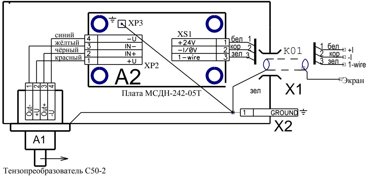
Рисунок A.4 – Схема соединений ДПА-327-03T
