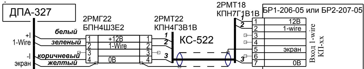
*Рисунок А.1 – Схема подключения ДПА-327-03Т к системе сбора по 1-Wire (в БР должен быть установлен модуль МВУ-225-02WI, МСД-211 и распаян разъем 2РМГ18Б7Ш1Е1 согласно РЭ на БР для 1-Wire)*
