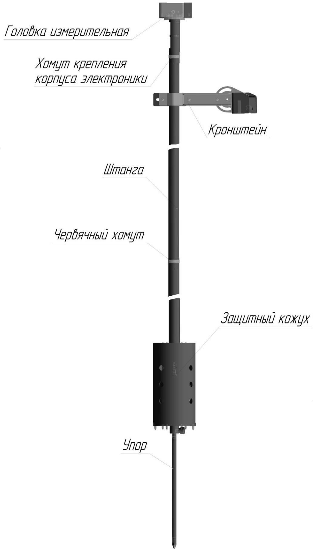
Рисунок 2 – Общий вид ДПА в рабочем положении
