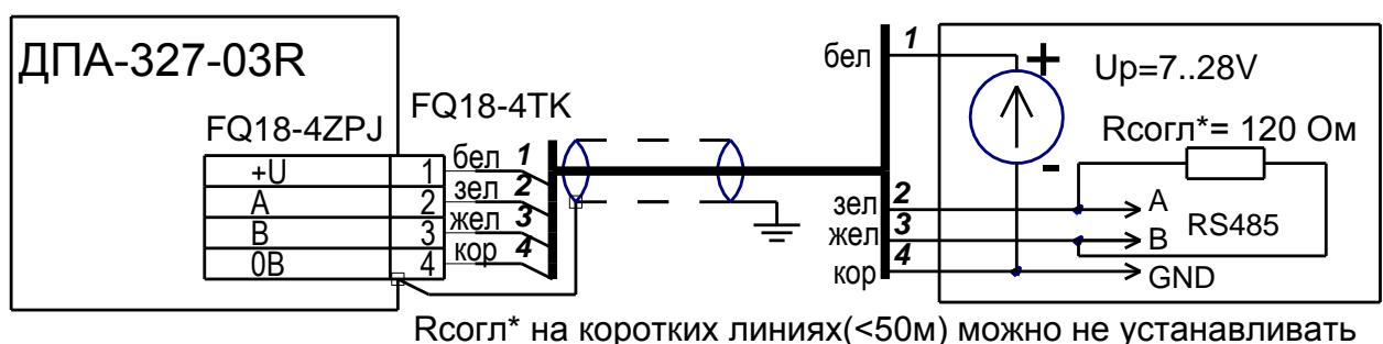
Рисунок A.6 – Схема подключения ДПА-327-03R к системе сбора информации ГТИ
