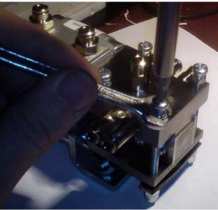
В случае, если ремонт проводится в полевых условиях, следует подать давление на прибор, вход прибора закрыть, а выход через трубку направить в емкость с водой. после чего постепенно поджимая пружины (выкручиваем винт против часовой) добиться уменьшения потока пузырьков.
