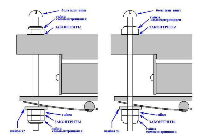
Основой конструкции является болт, который в отличие от старой конструкции развернут "шляпкой в верх", и зафиксирован законтренными гайками.
